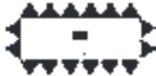
Flächen für Aufschüttungen; In dem gekennzeichneten Bereich ist eine durchgehende Aufwallung bzw. Mauer in einer Höhe von mindestens 0,20 m gegenüber dem ursprünglichen Gelände zum Schutz vor Hangwasser auszuführen und dauerhaft zu erhalten.
