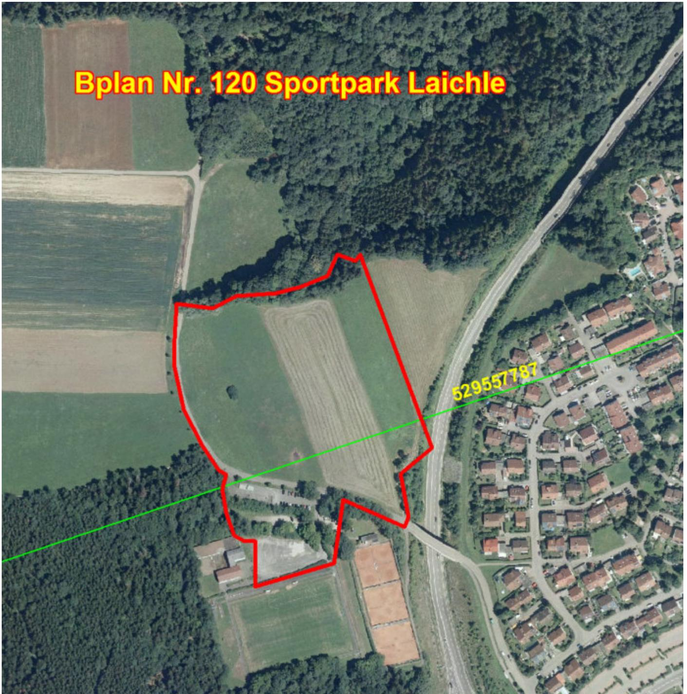
Die farbige Linie versteht sich als Punkt- zu-Punkt-Richtfunkverbindungen der Telefónica Germany GmbH & Co. OHG. Das Plangebiet ist im Bild mit einer dicken roten Linie eingezeichnet.
