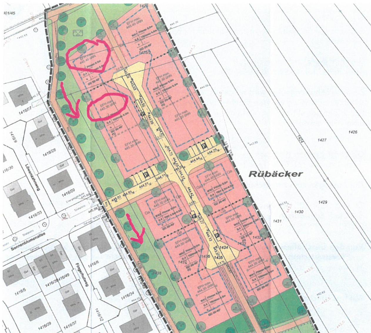
Abb. 2: mögliche Ableitung von wild abfließendem Hangwasser. EFH's mit geringer Schutzwirkung
