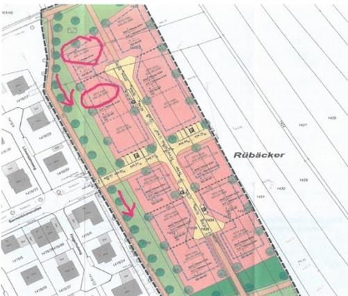
Abb. 2: mögliche Ableitung von wild abfließendem Hangwasser. EFHs mit geringer Schutzwirkung
