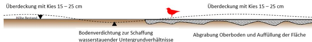
Abbildung 17: Schemazeichnung (Längsschnitt) der Kiesfläche (von: W. Lissak, Fachbüro für ökologische Planung, textlich verändert: B.Bauer)
